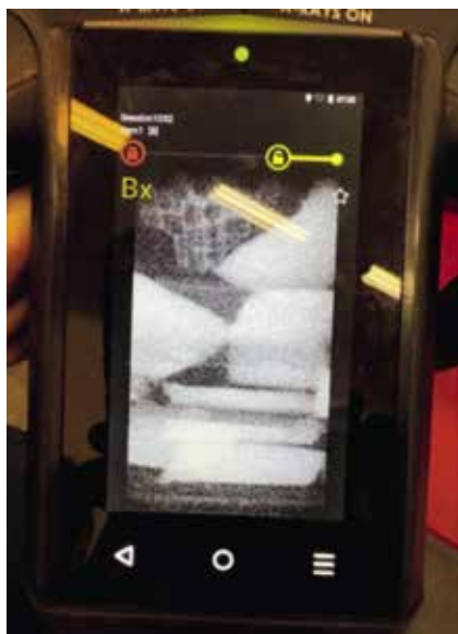
Handhållen röntgenmaskin är ett effektivt verktyg att upptäcka narkotika i dolda utrymmen.
